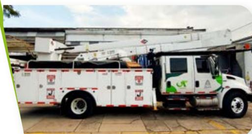
Dispositivos aéreos aislados de elevación y rotación montados en vehículos (vehículo canasta incluye liner)
