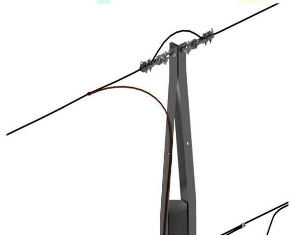
**Detalle B.** Conexión del bajante de puesta a tierra al conductor de neutro o cable de guarda.
