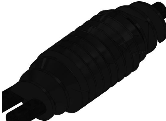
Ilustración 4. Aplicación de cinta PVC
