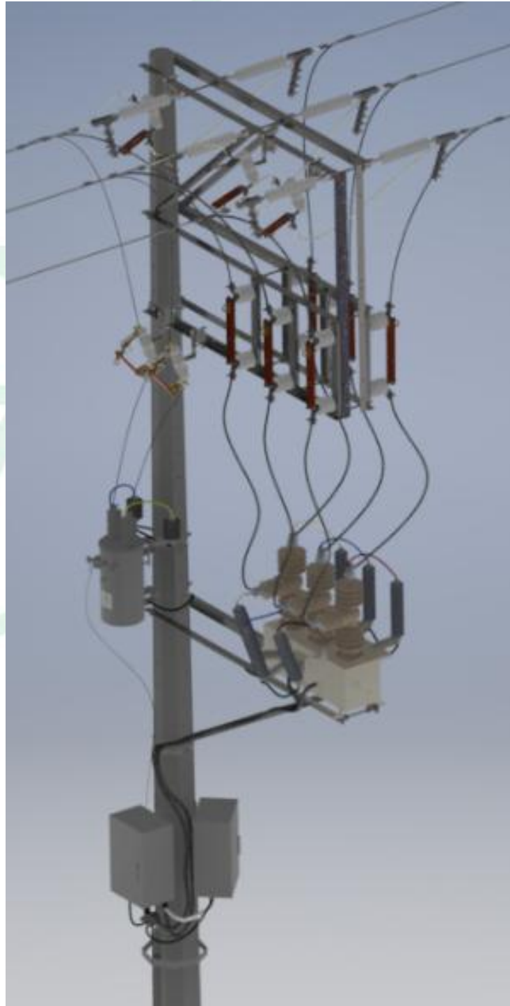
Figura 3. Esquema general del montaje del reconectador 13.2kV – Isométrico
