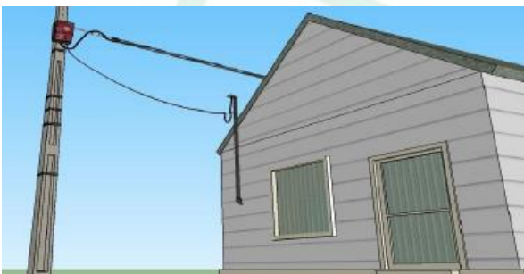
Figura 7. Medidor bicuerpo instalado en poste de acometida
