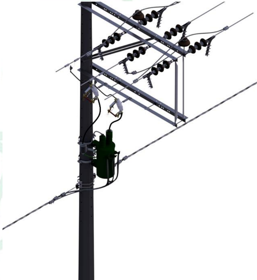
Figura 6. Esquema de montaje subestación tipo poste bifásica mostrado en la norma CNS-NT-03-08
