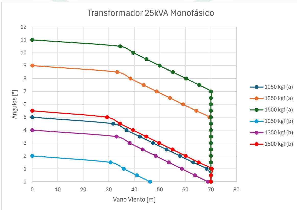
**Figura 5. Curva de utilización transformador monofásico de 25kVA**
