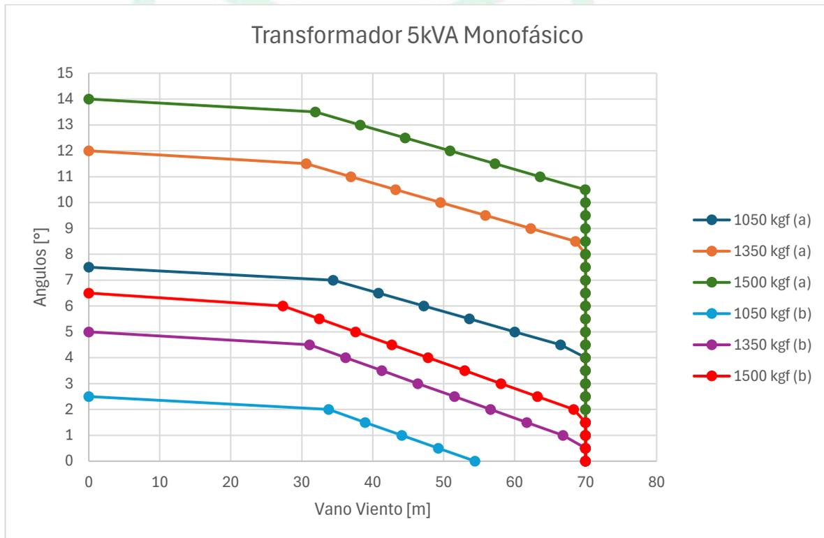
**Figura 1. Curva de utilización transformador monofásico de 5kVA**
