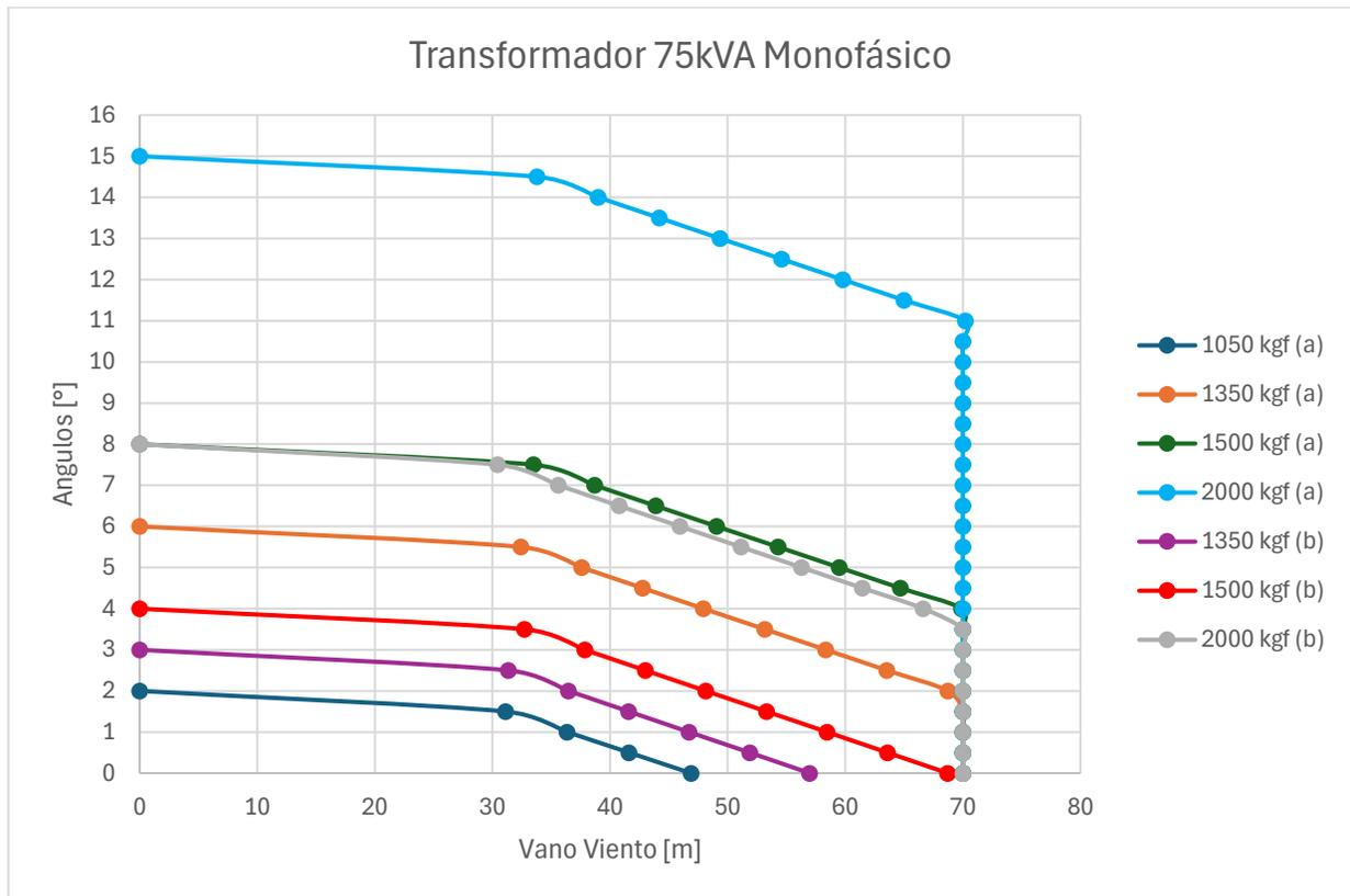
Figura 10. Curva de utilización transformador monofásico de 75kVA
