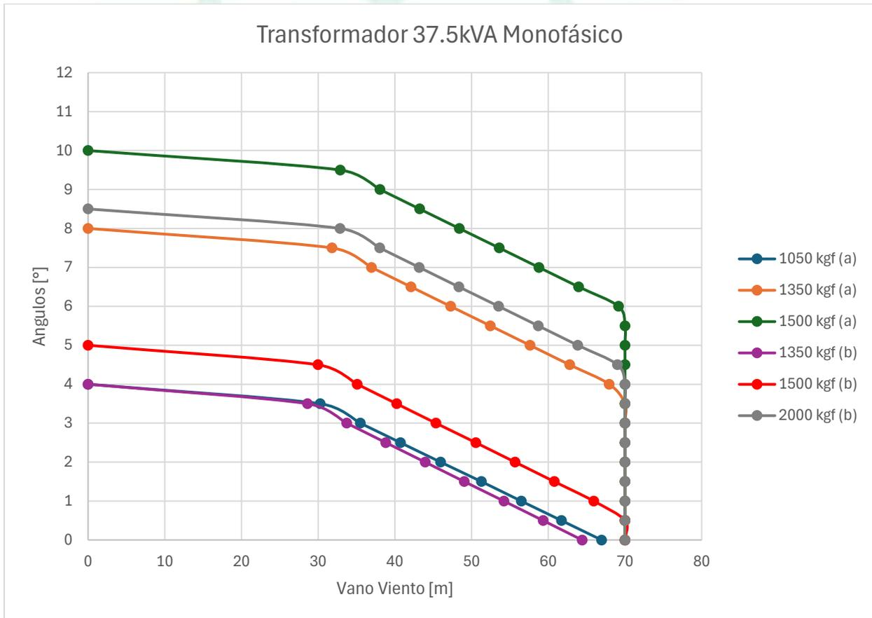
**Figura 7. Curva de utilización transformador monofásico de 37.5kVA**
