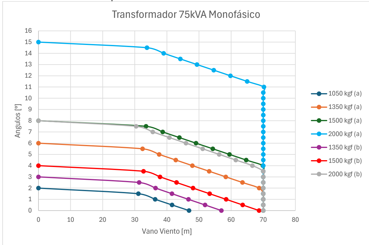
Figura 10. Curva de utilización transformador monofásico de 75kVA
