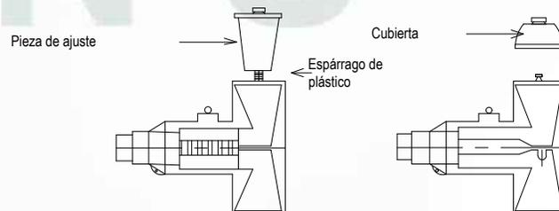
8- Adaptador del terminal tipo "T" a terminal tipo codo de 600 A de operar sin carga.
