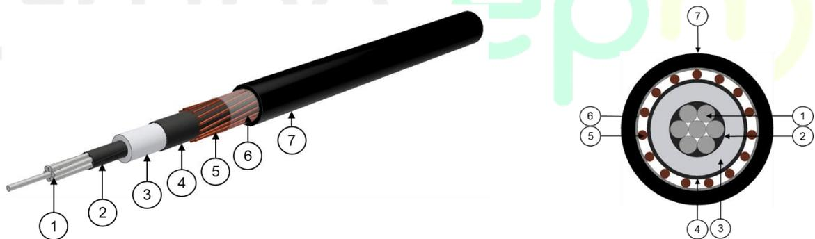
El cable multiplex se compone de uno, dos o tres cables monopolares de media tensión trenzados sobre un cable mensajero
