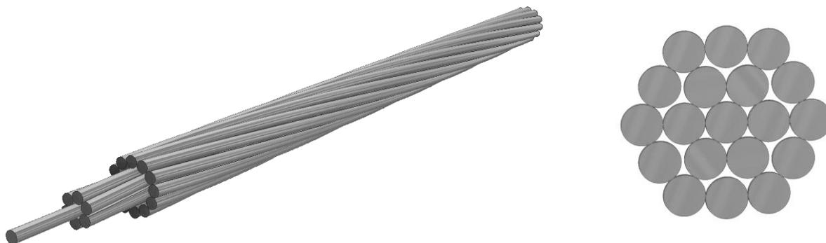
**Figura 4.** Esquema cable AAAC monopolar desnudo - 37 hilos
