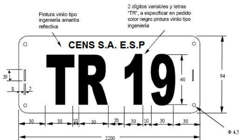
Figura 2 Placa para identificar los transformadores
