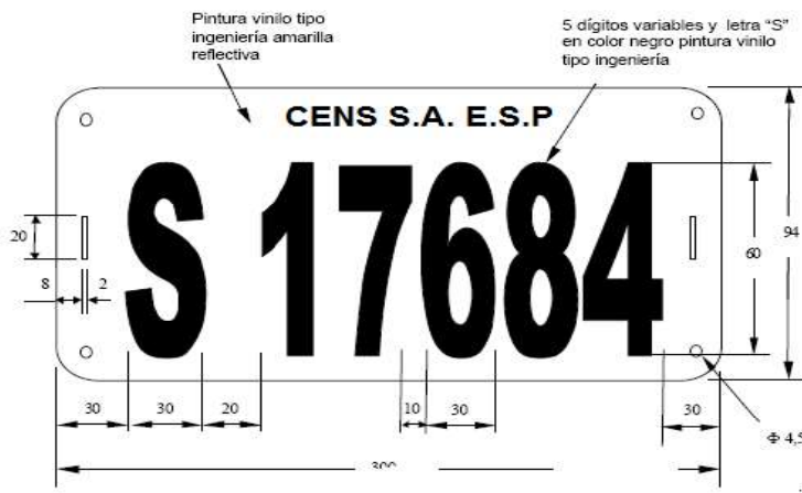
Figura 4. Placa para identificar los seccionadores
