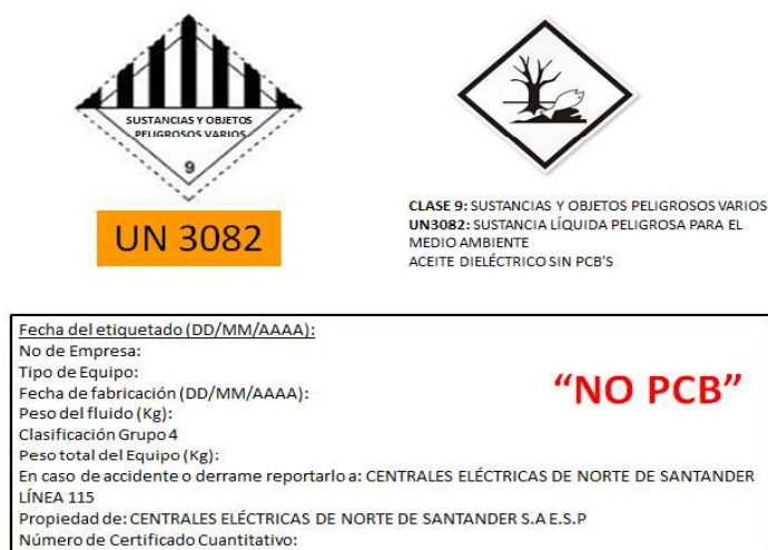
Figura 3. Etiqueta identificadora de "NO PCB"
