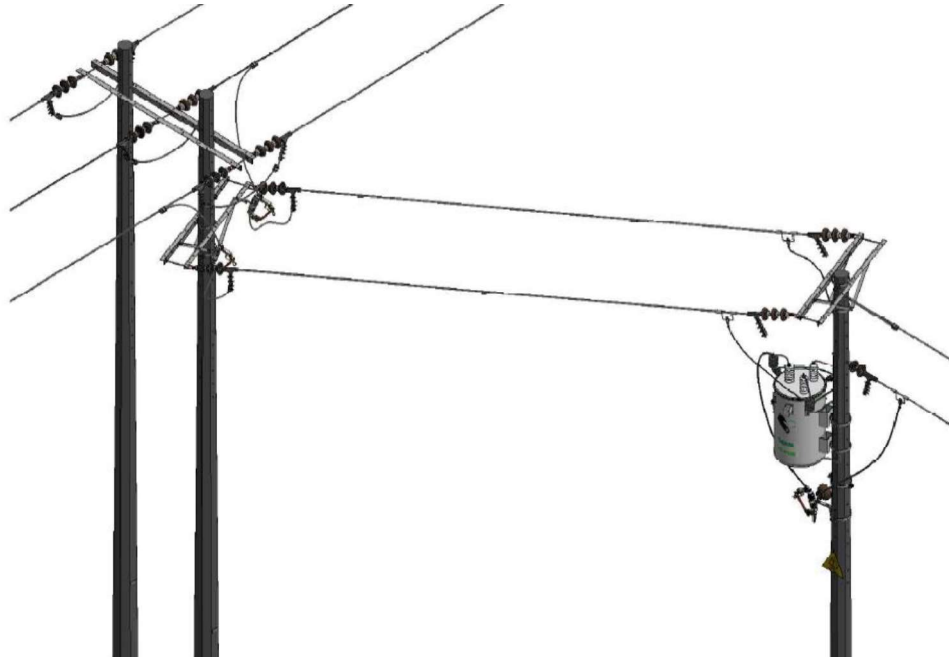
Figura 1 Transformadores con capacidad menor a 50 KVA en poste
