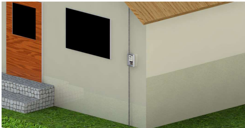
Figura 9. Fachada con medidor y ductos
