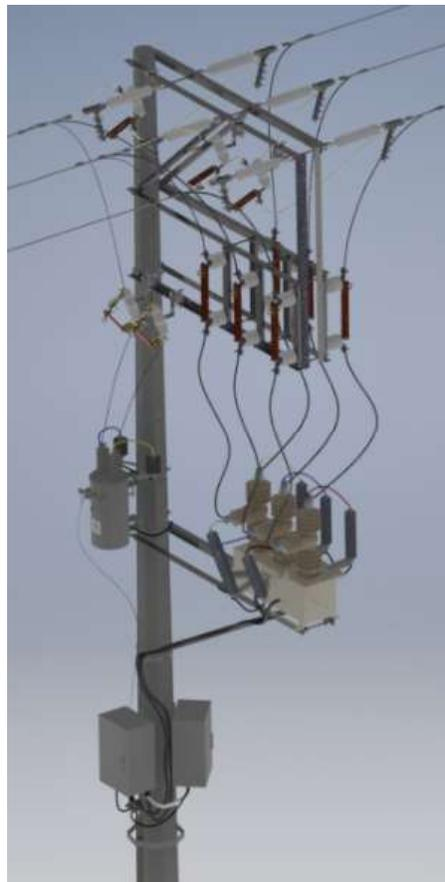
Figura 1. Esquema general del montaje del reconectador - Isométrico
