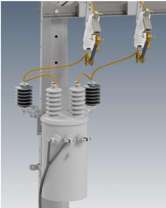
Figura 4. Detalle conexión del transformador
