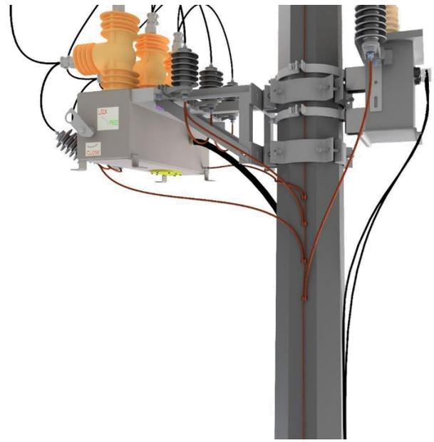
**Detalle A.** Bajante de puesta a tierra y conexión de puesta a tierra para los equipos.
