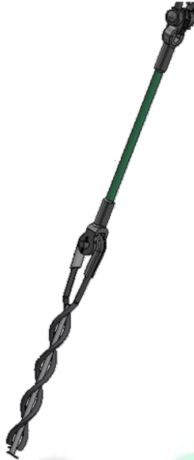
Figura 16. Conexión 3': cable de acero a aislador tensor
