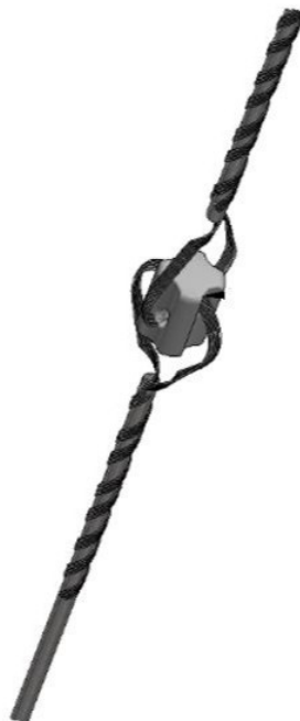
Figura 15. Conexión 3: cable de acero a aislador tensor
