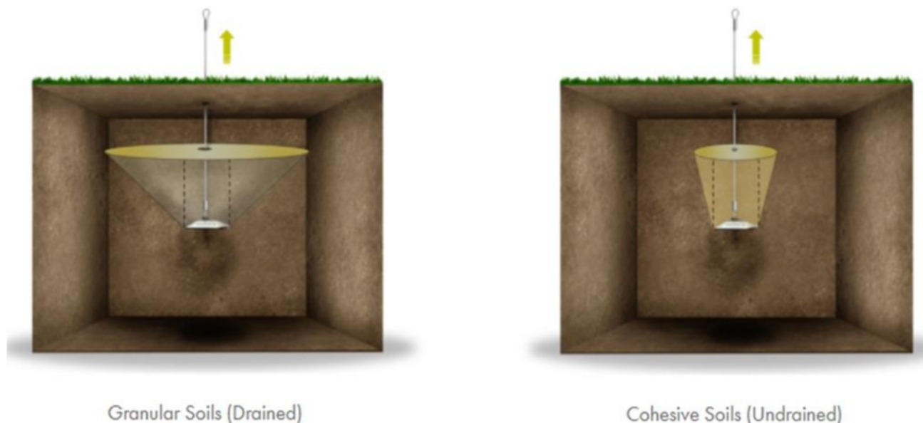
Figura 1. Formación de cuñas de suelo en función del tipo de suelo.
