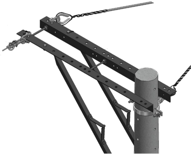
Figura 14. Conexión 2: cable de acero a cruceta
