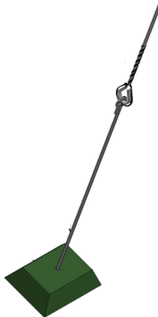
Figura 17. Conexión 4: cable de acero a varilla de anclaje
