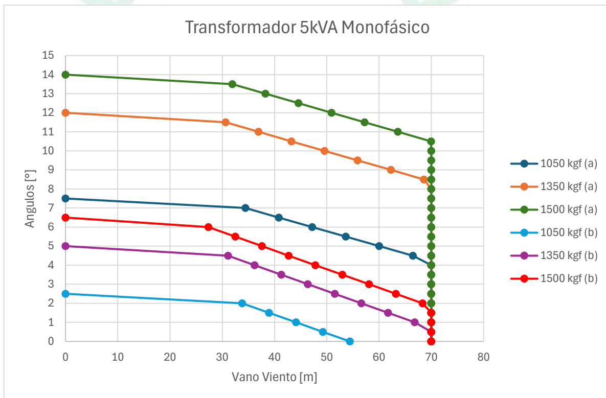
Figura 1. Curva de utilización transformador monofásico de 5kVA
