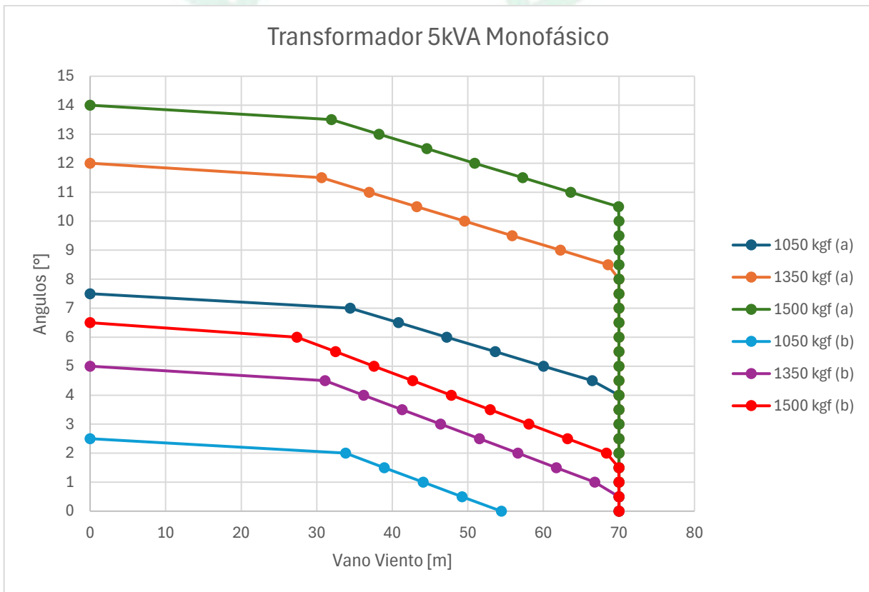
Figura 1. Curva de utilización transformador monofásico de 5kVA
