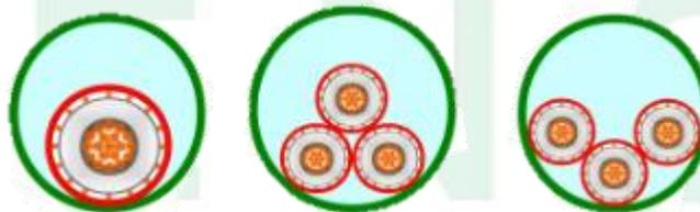
Figura 25. Acomodo de cables en un ducto
