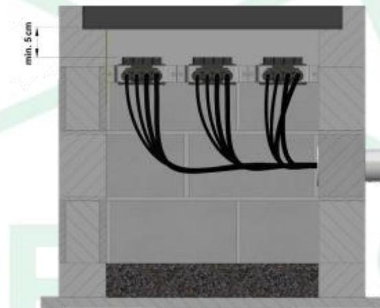
**Figura 12. Instalación de barraje de derivaciones**
