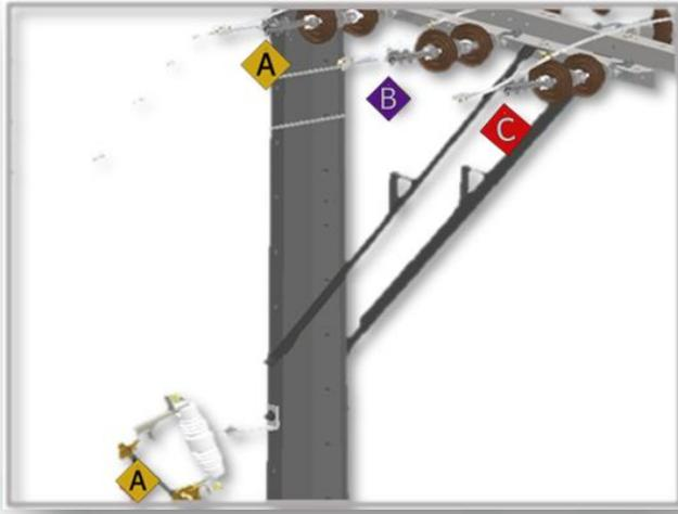
**Ilustración 18. Representación gráfica de la marcación en la derivación de ramal monofásico**
