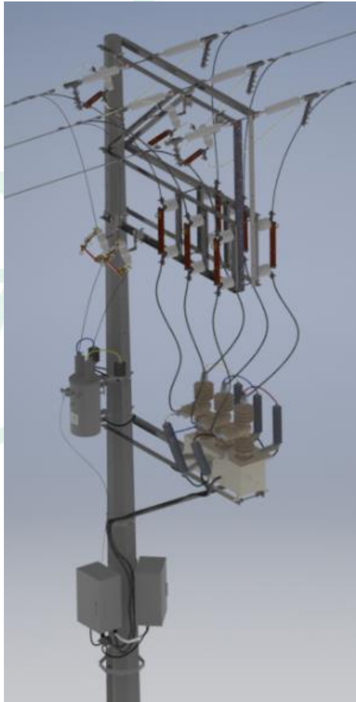
Figura 3. Esquema general del montaje del reconector 13.2kV – Isométrico
