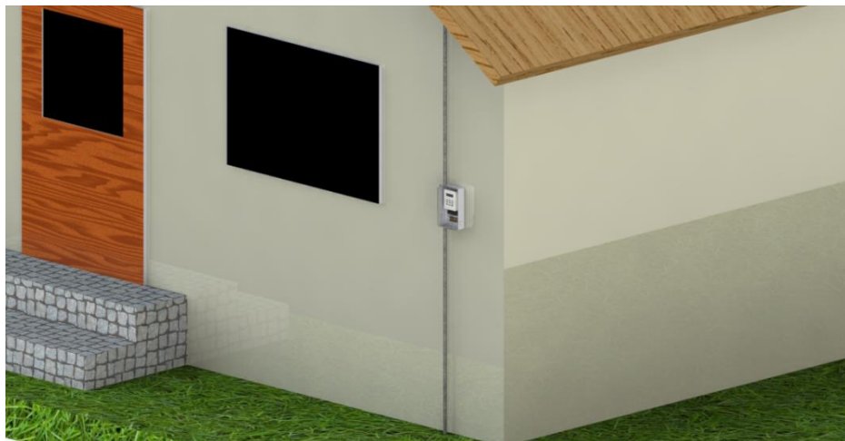
Figura 9. Fachada con medidor y ductos
