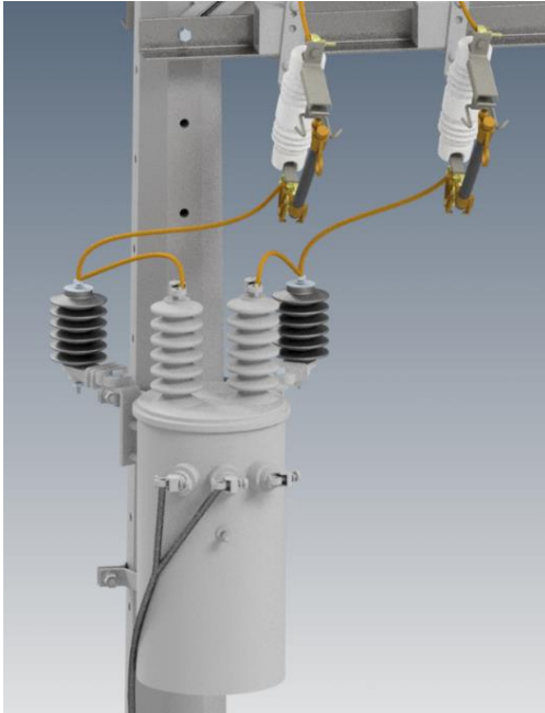
Figura 3. Detalle conexión del transformador
